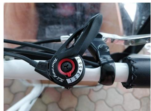
2. Kontrollieren Sie nun beim Zahnkranz des Hinterrades, ob das größte Ritzel auf dem die Kette läuft in einer Linie mit der Leitrolle im Schaltkäfig steht. Falls nicht, drehen Sie an der Schraube "L" bis dies der Fall ist.
