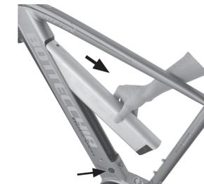
3. Nehmen Sie den Akku aus dem Gehäuse beziehungsweise der Akkuhalterung heraus.
