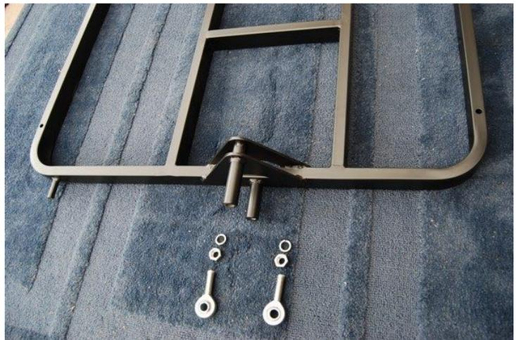
Auf dem Gewinde des Gelenkkopfes verwenden Sie (aus Sackerl 5) jeweils einen Federring Durchmesser 12 (A), sowie die passende Mutter (B).
