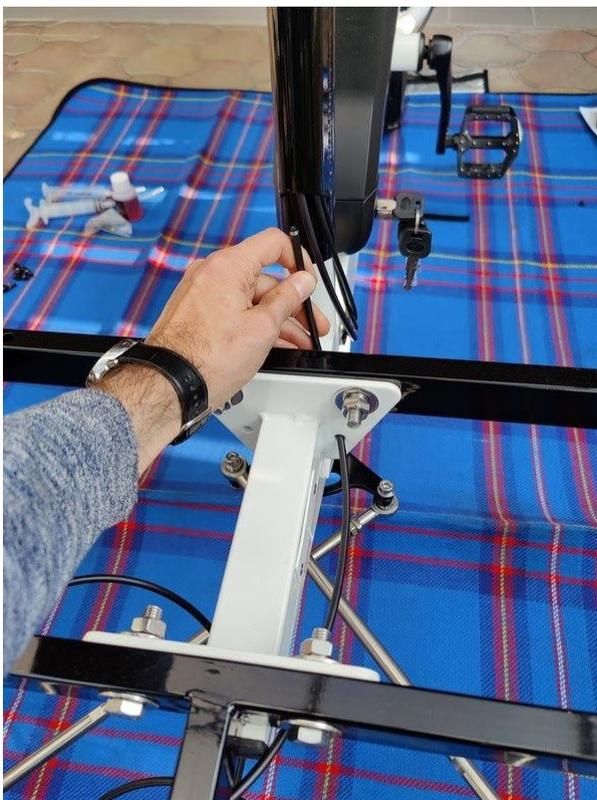
Schrauben Sie den T-Verteiler des Hydraulikschlauches mit den langen Zylinderkopf-Schrauben (aus Sackerl 7) an den Rahmen [Inbus 4].
