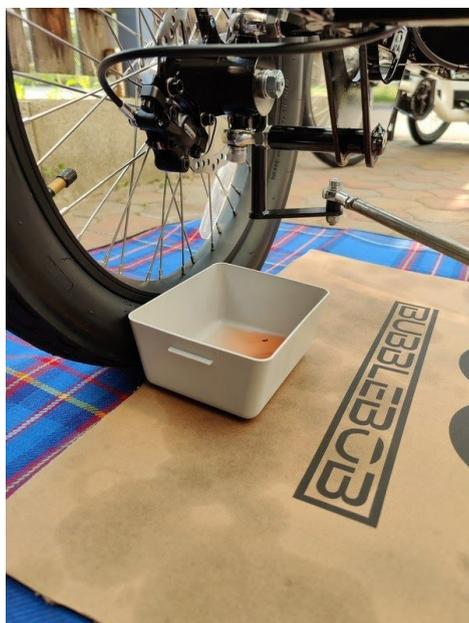
Platzieren Sie einen Abtropfbehälter unterhalb des linken Bremssattels (und vielleicht noch ein Stück Karton, ab jetzt wird es ein wenig ölig...).
