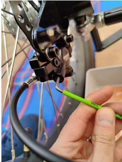
Entfernen Sie nun die fest verschlossene Madenschraube am Bremssattel [Torx 10]...
