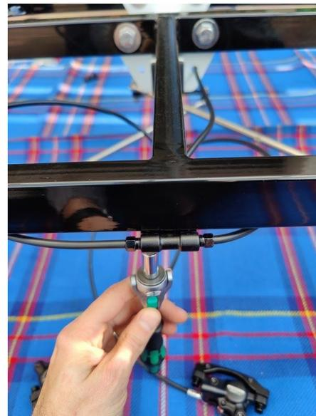
Schrauben Sie die Schlauchführung auf beiden Seiten an die Unterseite des Vorder-Rahmens [Kreuz-Schraubenzieher].
