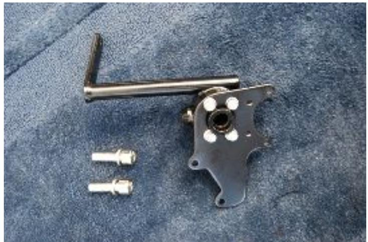
...und mit diesen den Greifer zwischen den Gelenkköpfen festschrauben. Achten Sie darauf, dass Sie so fest anschrauben, dass die erwähnten Montageschrauben sich mit dem Gelenklager mitdrehen, jedoch nicht so fest, dass sich der Greifer nur noch sehr schwer drehen läßt [Inbus 10].
