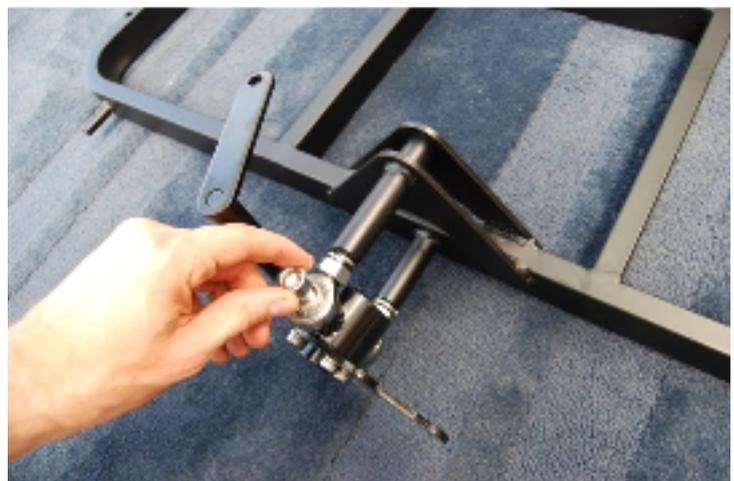
Ziehen Sie nun auch die Befestigungsschrauben der Gelenkköpfe (aus Schritt 1) an den Muttern fest [Maulschlüssel 19].
