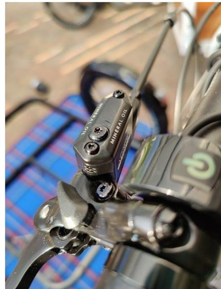
Schrauben Sie die Spritze ohne Druckkolben in diese Öffnung.
