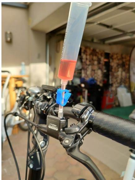
Drücken Sie etwa die Hälfte des Spritzeninhalts in das Hydraulik-System, und beobachten Sie dabei, wie sich die Spritze am Bremshebel oben zu füllen beginnt (möglicherweise mit kleinen Luftbläschen durchmischt - das ist gut so, die müssen sowieso aus dem System raus). Stoppen Sie, sobald die Spritze oben ca. 1cm gefüllt ist.
