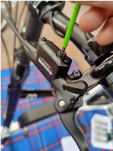
...und öffnen Sie die Zugangsschraube.
