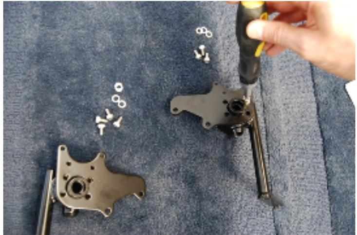
Hier im Bild ist der Greifer der (in Fahrtrichtung) rechten Seite zu sehen, bereits verschraubt. Die großen Zylinderkopf-Schrauben daneben im Bild (M12x35, aus Sackerl 5) mit einem Federring bestücken...
