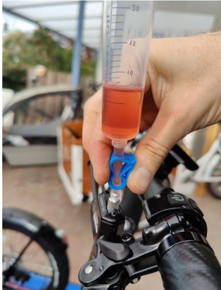
Steigen keine Bläschen mehr auf, dann drücken Sie den Schlauch zur Spritze ab, ziehen ihn vom Schlauch-Adapter, und entleeren den Inhalt in den Mineralöl-Behälter.
