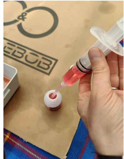
...und schrauben schnell die Spritze auf (je schneller Sie dies tun, desto weniger wird in den Abtropfbehälter tropfen).
