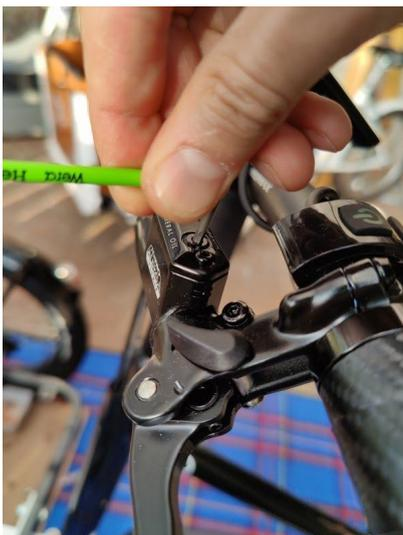
Drehen Sie den Spritzen-Adapter vom Reservoir ab, und verschließen Sie die Öffnung wieder (mittelfest, sodass die Gummidichtung nicht zerdrückt wird).
