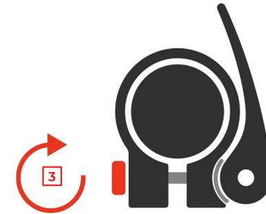
Dein YOONIT ist mit einem Höhenverstellungssystem für den Lenker ausgestattet. Mit Hilfe des Schnellspannmechanismus lässt sich der Lenker einfach und werkzeuglos in der Höhe verstellen.
