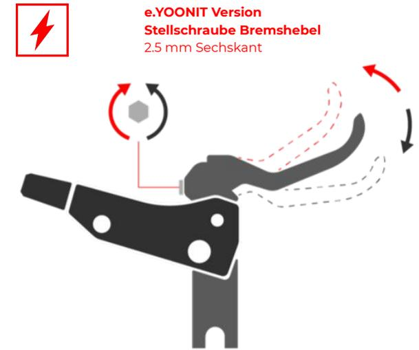
An deinem YOONIT wirkt der Bremshebel auf der linken Seite des Lenkers auf die Vorderbremse. Der Hebel auf der rechten Seite wirkt auf die Hinterradbremse.
